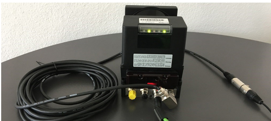
后视图，扫描方向向上：连接和 LED 指示灯从左到右
