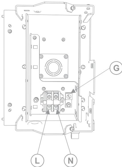
9. 将交流输入盖板提到适当的位置并用六个螺丝重新固定。
