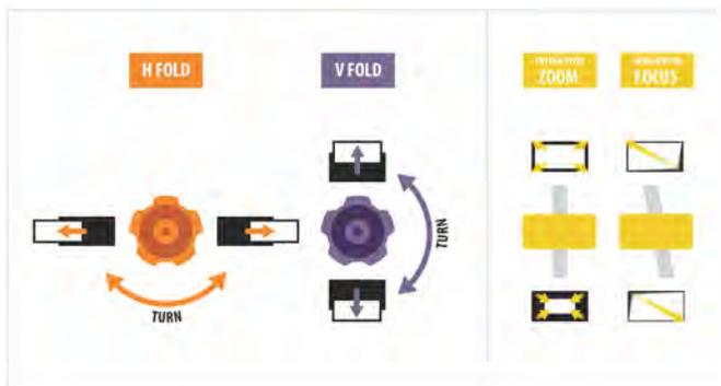
在进行调整时，请参阅测试图像以获得相关指导。测试图像的右侧面板提供了有关积分器变焦和焦点调整的信息。左侧面板提供有关折叠式反射镜调整的信息。
