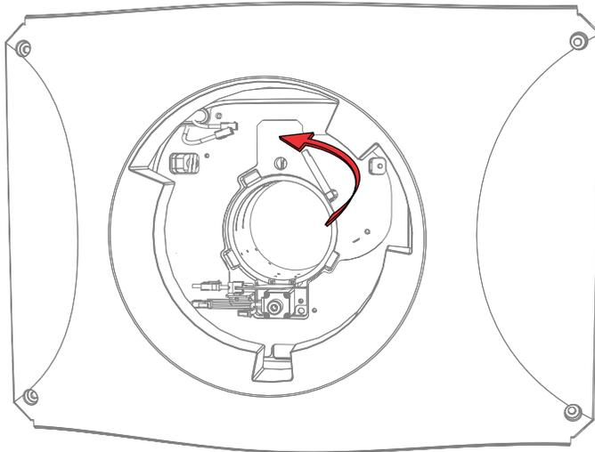
5. 将镜头完全插入镜头座开口，不要转动，直至到达停止位置。
