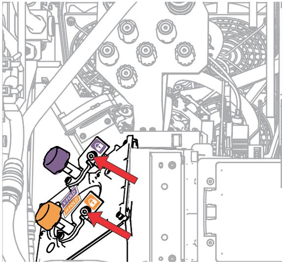
9. 要对折叠式反射镜进行水平调整，请使用橙色调整旋钮。
