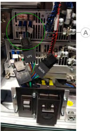
6. 将 UPS 插头上的保护帽放在主输入插头上。
