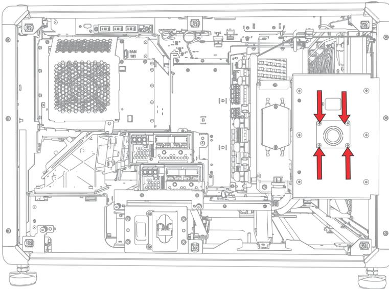
3. 要打开投影机的交流输入区域，请拆下固定盖板的六个螺丝，然后向下转动盖板将其打开。
