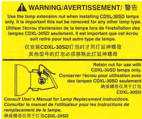
表示僅在安裝 CDXL-30SD 燈泡時使用燈泡延長螺帽。對於所有其他燈泡類型，必須卸下此螺帽。
