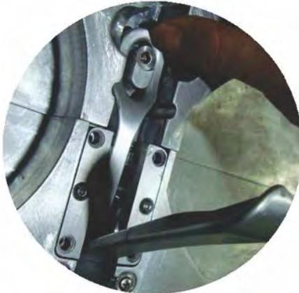
对所有面板的锁机构螺钉做出相同的调整。如果螺钉在所有面板上的深度不一致，则不会校正面板，面板之间不均匀的张力也会影响影像质量。
