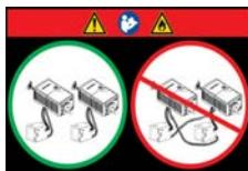
Weist darauf hin, dass in einer Installation mit mehreren Projektoren Brandgefahr besteht, wenn die Starkstrom-Gleichstromkabel und die Vorrangschalter- bzw. Steuerkabel zwischen den Projektorköpfen und den Lampenstromversorgungen falsch miteinander verschaltet werden. Stellen Sie sicher, dass die Starkstromkabel (DC) und Vorrangschalter-/ Steuerkabel korrekt mit der Lampenstromversorgung (LPS) und dem entsprechenden Projektor verbunden sind. Ansonsten kann es zu einer Brandgefahr kommen.
