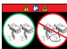
複数のプロジェクターを取り付ける場合、プロジェクターヘッドとランプ電源 (LPS) の間で、高電流 DC ケーブルとインターロック / 制御ケーブルが誤って交差接続された場合、火災の危険があることを示します。高電流の DC リード線とインターロック / 制御ケーブルが、ランプ電源 (LPS) とプロジェクターとの間で正しく接続されていることを確認してください。この指示に従わない場合、火災が発生する危険があります。
