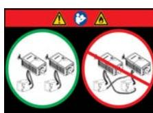
여러 대의 프로젝터를 설치할 때 프로젝터 헤드와 램프 전원공급장치 간의 고전류 DC 케이블 및 인터로크 / 컨트롤 케이블이 제대로 연결되지 않은 경우 화재 위험이 있음을 나타냅니다. LPS(램프 전원 공급 장치)와 해당 프로젝터 간의 고전류 DC 도선 및 인터로크 / 컨트롤 케이블이 올바르게 연결되었는지 확인하십시오. 이를 준수하지 않으면 화재가 발생할 수 있습니다.
