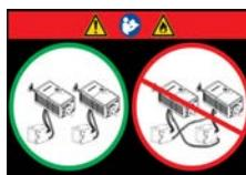
Указує на те, що в системі з декількома проекторами існує ризик займання, якщо з'єднання між проекційними модулями та джерелами живлення ламп сильнострумними кабелями постійного струму та кабелями блокування/керування виконано невірно. Переконайтесь, що сильнострумні кабелі постійного струму та кабелі блокування/керування підключено правильно між джерелом живлення лампи та відповідним проектором. Невиконання цієї вимоги може привести до займання.
