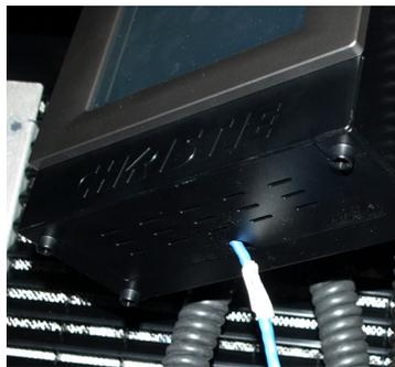
4. 将以太网电缆的另一端连接到机架开关。
