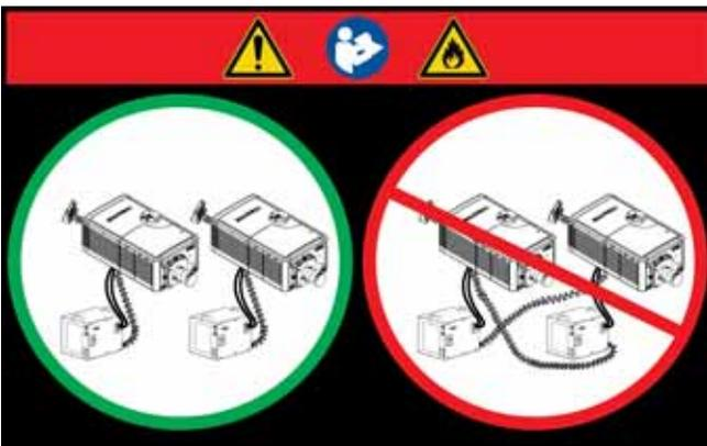
此标签用来警示一次安装多个投影机时，会发生交叉连接的危险。如果灯泡电源联锁电缆连接到了错误的投影机，则存在火灾危险。
