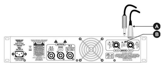
**A** 连接到 CH. A 输入的 3-芯 XLR, 或 6.3 mm (1/4 英寸)的耳机插孔
