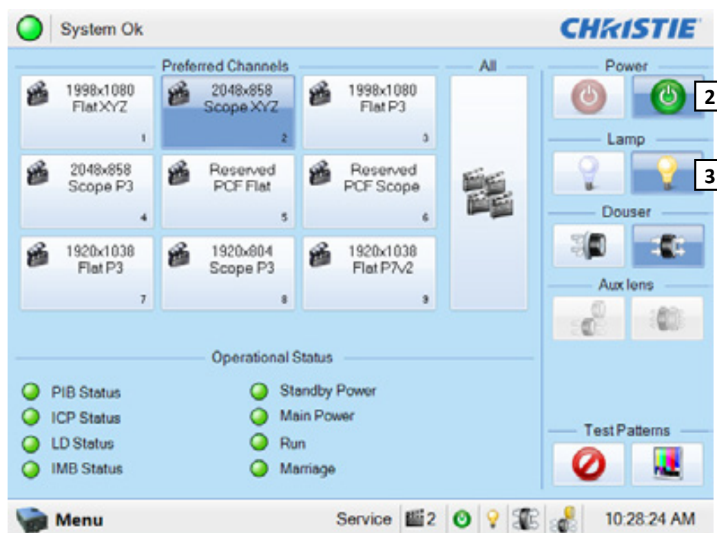
图 3-1 Power ON（开启）和 Lamp ON（开灯）按钮都在 TPC 上
