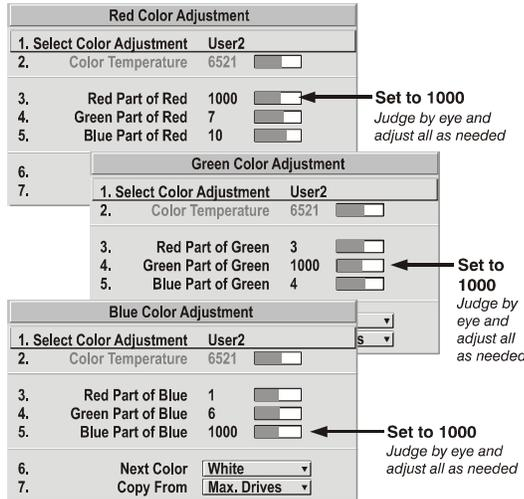
FIGURE 4-22 COLOR MATCHING USING COLOR SATURATION MENU
