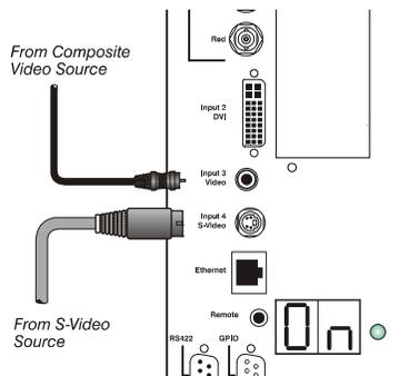
FIGURE 2-15 CONNECTING COMPOSITE / S-VIDEO
