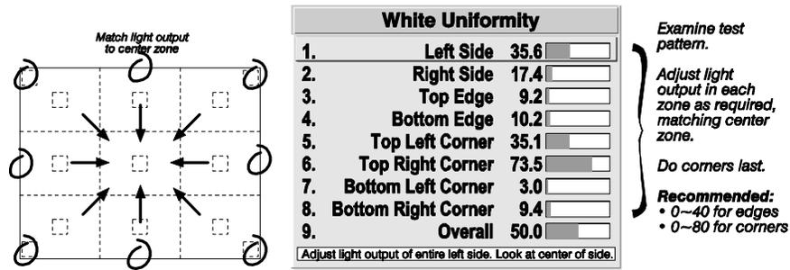
FIGURE 4-24 MATCH ZONES TO CENTER LIGHT OUTPUT
