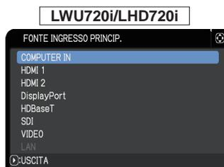
**NOTA** • Se si seleziona SEGUI UNITÀ PRINCIPALE, selezionando la fonte di ingresso sul proiettore Principale o su quello Secondario, l'altro proiettore si imposterà automaticamente sulla stessa fonte.
