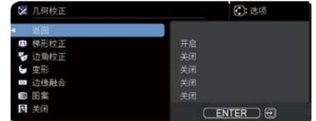
**通知事项** · 如数秒钟无动作，菜单或对话框将自动消失。再次按**GEOMETRY**按钮，或把光标指向对话框的关闭，按▶或**ENTER**按钮结束操作，关闭菜单或对话框。
