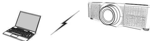
Fig. 3.3.a Communication sans point d'accès (Point D'accès Simple)
