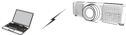
Рис. 3.3.а Связь без точки доступа (Ad Hoc)
