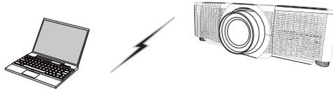
Fig. 3.3.a Kommunikation ohne einen Access Point (Ad Hoc)
