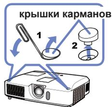
**ПРИМЕЧАНИЕ** • Карманы для хранения крышек находятся внутри заслонки регуляторов объектива. Обязательно храните крышки в карманах для хранения после их снятия с карманов стека.
