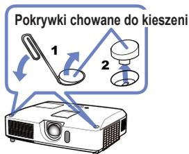
**UWAGA** • Kieszenie na przechowywanie pokrywek chowanych do kieszeni znajdują się wewnątrz osłony regulatora obiektywu. Po zdjęciu pokrywek z kieszeni stosowania należy je przechowywać w kieszeniach na przechowywanie pokrywek.
