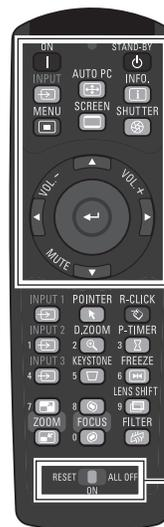
当简易模式设定为**开**时，只能使用简易模式按键。只有在设定遥控器代码或输入密码时（第 54、60 页），[ON 键、STAND-BY 键、INPUT 键、AUTO PC 键、INFO. 键、MENU 键、SCREEN 键、SHUTTER 键、▲▼◀▶ 键、SELECT 键、VOL.+ 键、VOL.- 键、MUTE 键、RESET/ON/ALL-OFF 开关] 和数字按键（第 14 页）才能使用。
